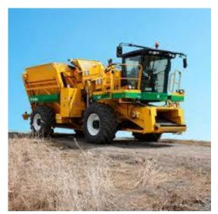
Sono macchine in grado di effettuare la raccolta completa, mediante l'impiego di un sistema pettinatore-raccoglitore e sbaccellatore-sgranatore
